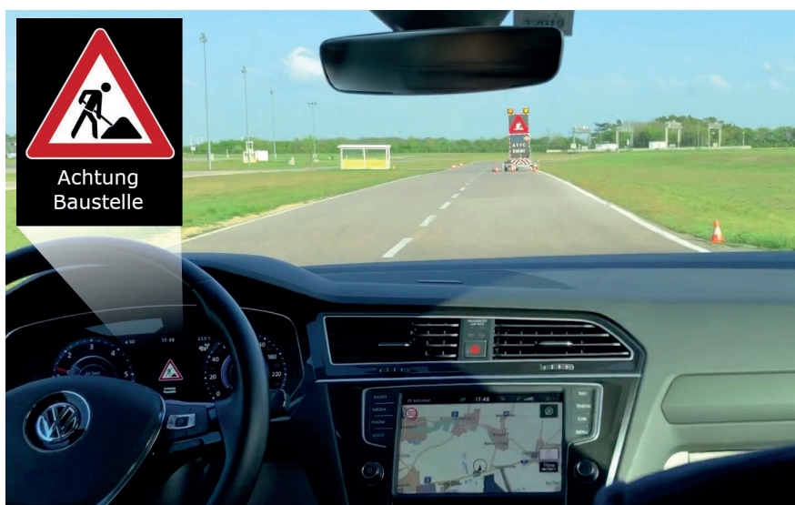
Bild 2: Baustellenwarnung über V2X-Kommunikation. © ASFINAG
